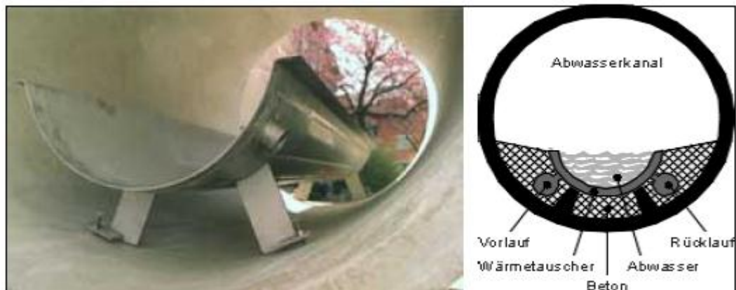
Abb. 3 Beispiel Rinnenwärmetauscher für Kanäle mit Kreisprofil
